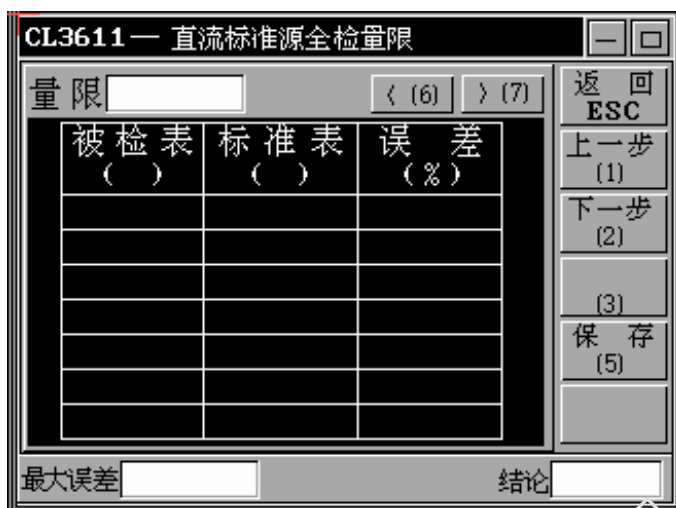
图 29 直流标准源全检量限校验界面
