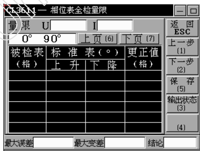
图 19 携带式相位表全检量限校验界面
