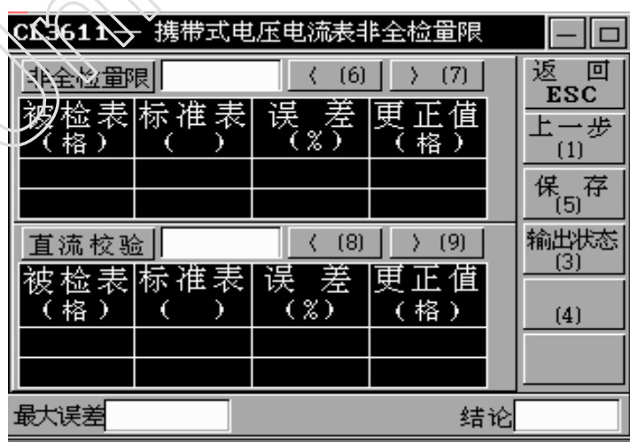
图 15 便携式电压表、电流表非全检量限校验和直流校验界面
