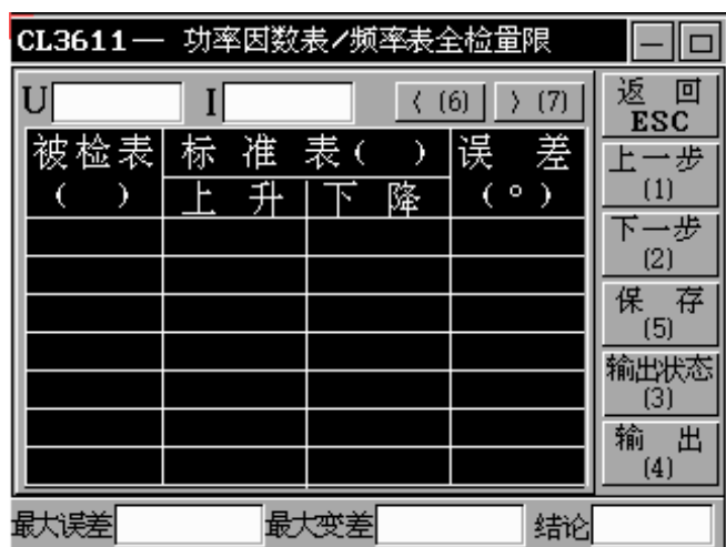
图 21 便携式功率因数表全检量限校验界面
