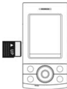
MMC 卡的安装朝向示意图
